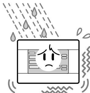
L'installation dans un endroit exposé à l'humidité, aux éclaboussures ou à d'importantes vibrations risque de provoquer des dysfonctionnements.
